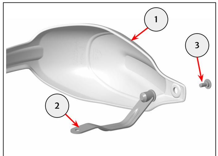
**3** Coloque un separador de extremo del manillar (1), el guardamanos izquierdo (2) y el peso de extremo del manillar reutilizado (3) en el extremo del manillar, tal y como se muestra.
