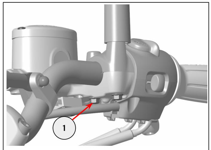
**9** Coloque el separador largo (1) entre el soporte del cilindro maestro delantero (2) y el soporte (3). Alinee el soporte del cilindro maestro delantero con la marca de alineación (4) y fíjelo con una fijación M6 x 55 mm (5) del kit.
