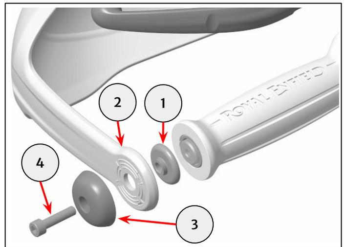
**4** Retire la fijación de la abrazadera del embrague (1) y guárdela para volver a utilizarla si la motocicleta se fuera a devolver a su estado original.
