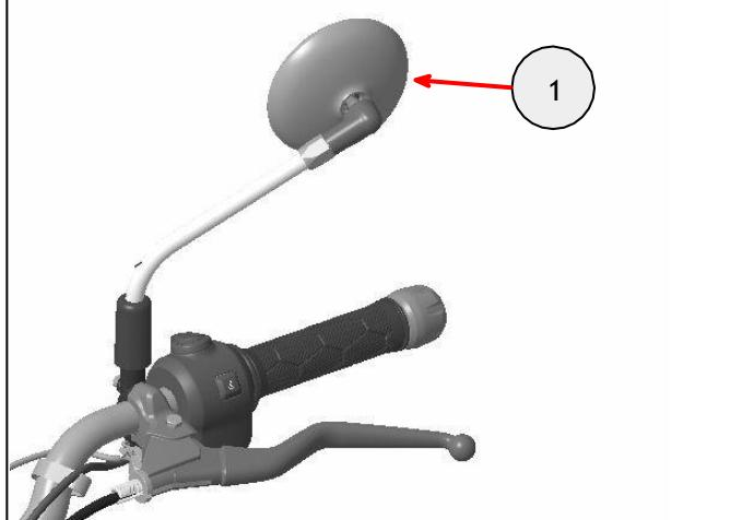
**2** Solte a fixação (1) no retrovisor de extremidade do guidão esquerdo (2). Coloque um suporte para extremidade do guidão (3) no retrovisor de extremidade do guidão com a flange (4) posicionada como mostrado.
