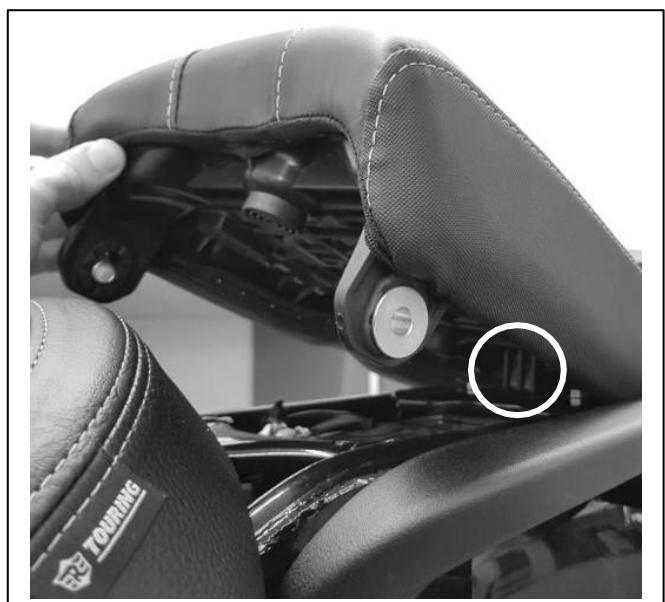
**9** Fixe novamente o assento do passageiro reutilizando o parafuso de cabeça cilíndrica (1) removido anteriormente. Insira através do ressalto da alça de segurança e no quadro. Torqueie a **25 Nm** e repita do outro lado.
