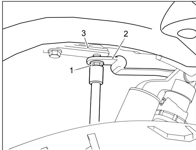
**3** Bring die vordere Haltegriffbefestigung (1) wieder an. Ziehe die Befestigung (1) auf  $25 \text{ Nm}$  an.
