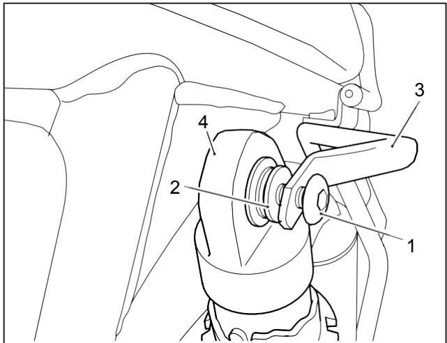
**2** Entferne die vordere Haltegriffbefestigung (1), mit der der Hebegriff (2) am Motorradrahmen (3) befestigt ist. Baue den Hebegriff vom Motorrad ab. Bewahre den Hebegriff für den Fall auf, dass die Zubehör-Zierbeschläge der Hinterradaufhängung ausgebaut werden sollen.
