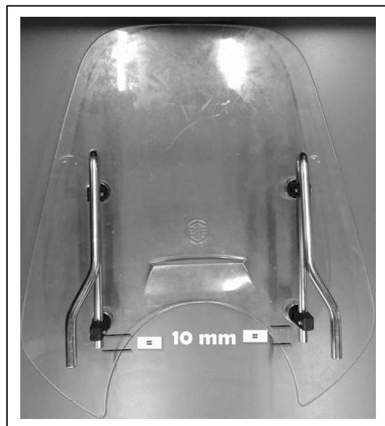
**7** Assembler sans serrer le support inférieur (2) avec un boulon M6 (12) et un écrou M6 (15). Répéter cette étape pour le support inférieur restant.
