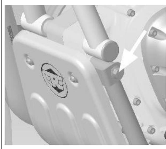
**7** Verifique o funcionamento de todos os controlos, incluindo pedais do câmbio e do freio para verificar a folga em relação ao protetor do cárter antes de operar o veículo.
