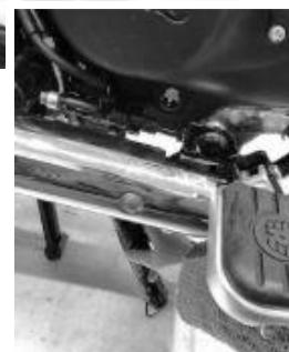
**3** Remova o parafuso de fixação dianteiro do motor (indicado pela seta), Arruela (3) e porca U (1). Monte o suporte de montagem dianteiro (2) como ilustrado, deixando o parafuso solto neste estágio.
