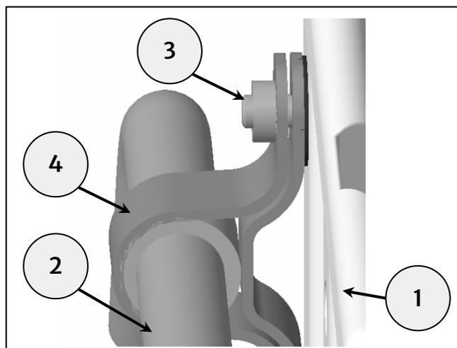
**11** Faites pivoter les supports intérieurs (1) et installez les manchons à bride (2) dans les trous de montage du boîtier latéral dans le sens indiqué. Faites passer les fixations M6 x 16 mm (3) dans les manchons à bride (2) des supports de montage intérieurs (4) et dans les supports intérieurs (1). Serrez légèrement les fixations dans les supports de montage extérieurs (5). Ne serrez pas complètement les fixations à ce stade.
