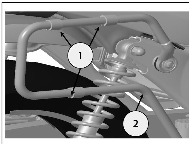
**5** Installez les supports de montage extérieurs (1) sur les poignées de montage (2) dans le sens indiqué.
