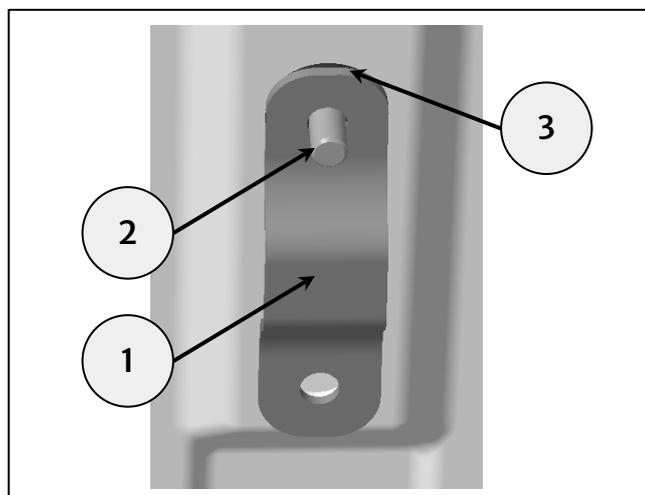
**10** Positionnez le boîtier latéral (1) sur le porte-sacoche (2) en vous assurant qu'il est correctement aligné comme décrit à l'étape 6. Serrez légèrement les fixations (3) dans les supports extérieurs (4) dans les positions de montage supérieures afin de maintenir le boîtier latéral en position. Ne serrez pas complètement les fixations à ce stade.
