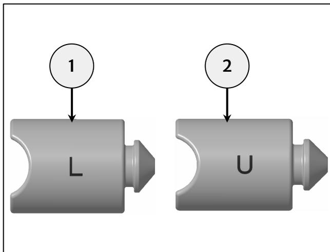
**3** Poussez et tournez les supports en caoutchouc supérieurs (1) et inférieurs (2) sur le boîtier latéral (3), comme illustré. Assurez-vous que la tête des supports en caoutchouc (4) est correctement positionnée à l'intérieur du boîtier latéral.
