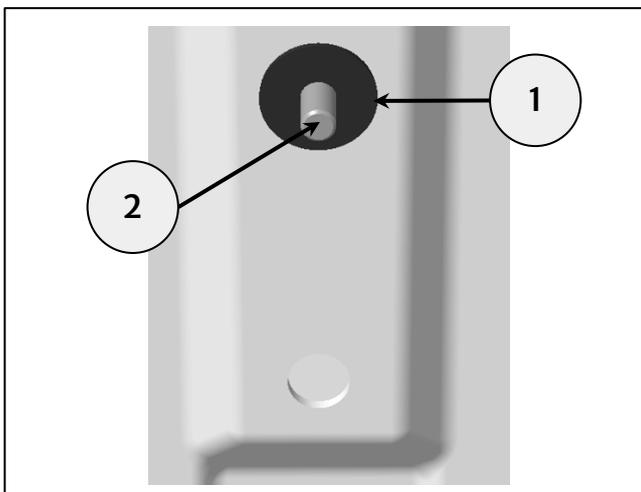
**9** Installez les supports de montage intérieurs (1) sur les fixations (2) contre les manchons à bride (3) dans le sens indiqué.
