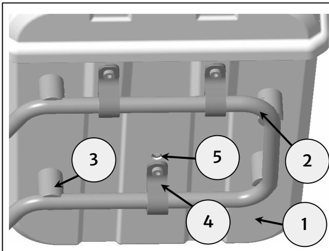
**7** Sans déplacer aucun des composants alignés, retirez soigneusement le boîtier latéral du porte-sacoche. Placez le support de montage intérieur (1) dans le boîtier latéral et alignez-le avec les trous de montage du boîtier latéral. Faites passer deux fixations M6 x 16 mm (2) du kit dans les trous supérieurs du support intérieur.
