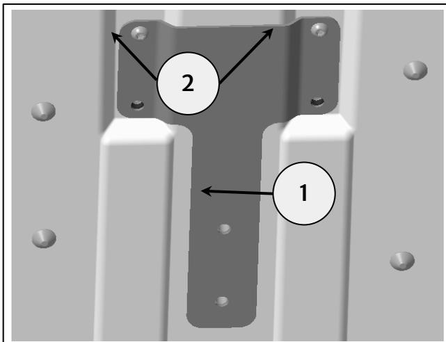
**8** Depuis l'extérieur du boîtier latéral, installez les manchons à bride (1) du kit sur les fixations M6 x 16 mm (2) dans le sens indiqué. Assurez-vous que les manchons à bride se positionnent correctement dans les trous de montage du boîtier latéral.
