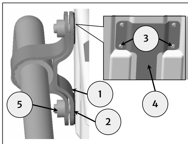
**12** Installez les entretoises (1) dans les trous de montage inférieurs du boîtier latéral. Faites passer les fixations M6 x 30 mm (2) du kit dans les trous de montage inférieurs du support de montage intérieur (3) et des entretoises (1). Installez le support de montage intérieur restant (4) sur les fixations dans le sens indiqué. Serrez légèrement les fixations dans le supports de montage extérieur (5). Ne serrez pas complètement les fixations à ce stade.
