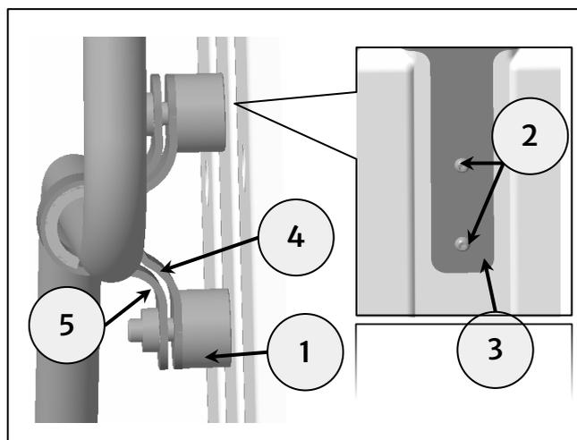
**13** Vérifiez que le boîtier latéral est correctement aligné sur le porte-bagages et serrez toutes les fixations (1) à **8 Nm**.
