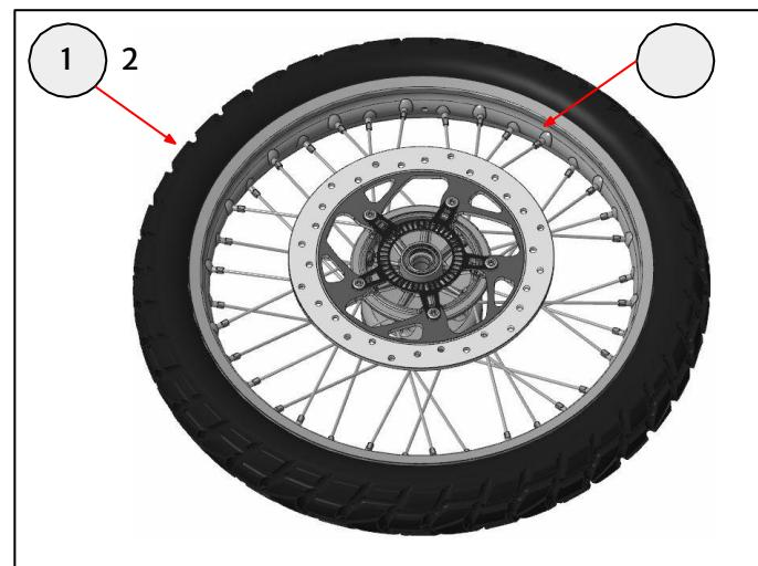
**3** Coloque el neumático (1) en la nueva rueda (2). La flecha de giro del neumático debe apuntar hacia delante.
