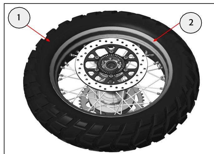
**7** Coloque el neumático (1) en la nueva rueda (2). La flecha de giro del neumático debe apuntar hacia delante.
