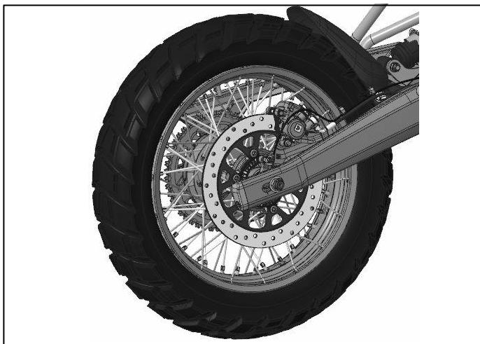
**6** Retire el neumático (1) de la llanta (2).
