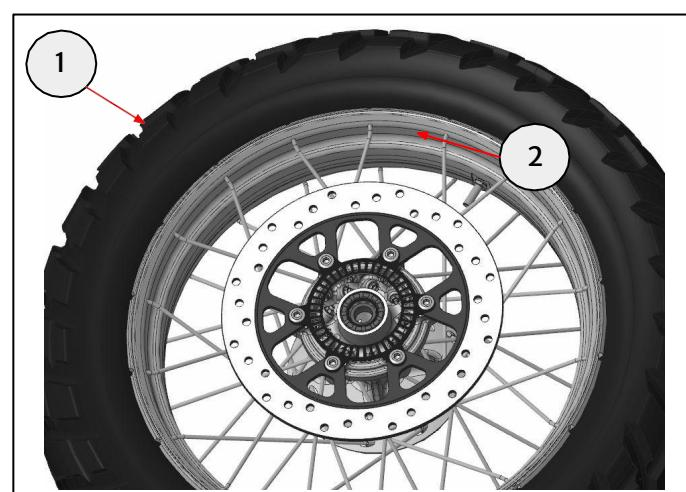
**8** Coloque las cuatro gomas de amortiguación del kit (1) en el buje.
